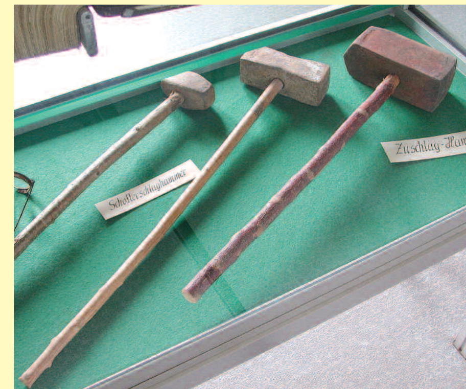
Von links: Schotterschlaghammer, Zuschlaghammer leichter Schlag (großer Abrichtehammer) und Zuschlaghammer schwerer Schlag (Vorschlaghammer). „Schwerer Schlag“ und „leichter Schlag“ sind Werkzeuge für die Knüppelschläger.
