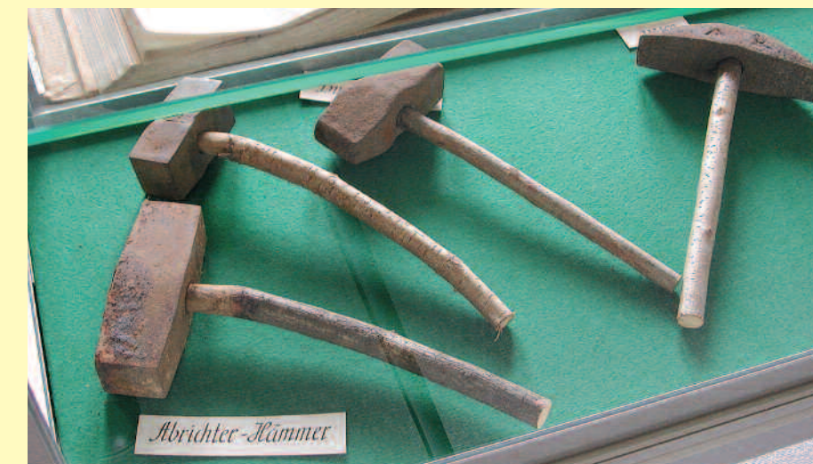
Arbeitsgeräte für den Abrichter (von links): Grösserer und kleinerer Abrichtehammer zum Formatieren vorgegebener Grössen, Pinnhammer (Pinne) für den groben Vorschlag und die Bille für die Oberflächenbearbeitung
