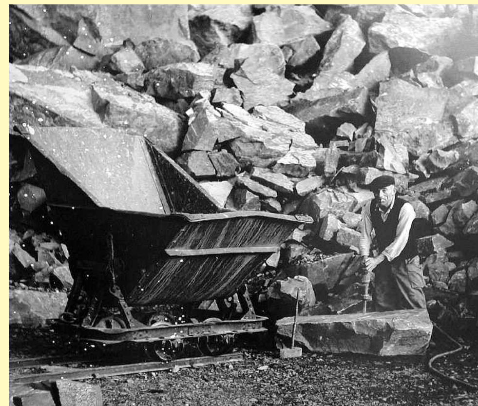
Brockenmacher und gleichzeitig Knüppelschläger mit Stosshammer (Druckluft) und danebenstehendem schwerem Hammer (Vorschlaghammer, Schlägel) für schweren Schlag.
